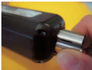
**Instalación del filtro:** Colocar el nuevo filtro con la cara rotulada hacia el interior del extremo ranurado del cambiador de filtros hasta la posición de stop. No lo incline.
