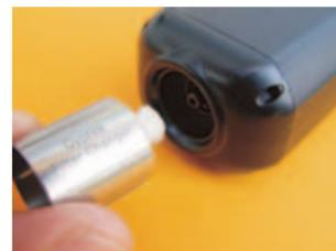
Sujetar el cambiador de filtros por el extremo no ranurado y, suavemente, deslizar el filtro en la unidad manteniéndolo recto y sin inclinaciones. Girar el cambiador de filtros en el sentido de las agujas de reloj. Al principio se notará una ligera resistencia. Continúe girando el cambiador de filtros hasta que gira libre sobre el filtro (el filtro se parará, pero el cambiador continuará girando). Retirar el cambiador de filtros, simplemente tirando hacia fuera.
