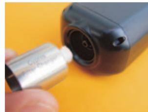
Den Filterwechsler im Bereich ohne Nuten fassen und den Filter mit dem Bajonettverschluß voran in das Gerät eindrehen. Dabei nicht verkanten. Der Bajonettverschluß des Filters muß anfänglich fast ohne Widerstand in das Gehäuse einzuführen und drehbar sein. Den Filterwechsler drehen bis er sich über dem Filter weggedreht hat (Filter ist stehengeblieben und Filterwechsler hat sich noch gedreht). Dann den Filterwechsler ohne zu verkanten vom Filter abziehen.
